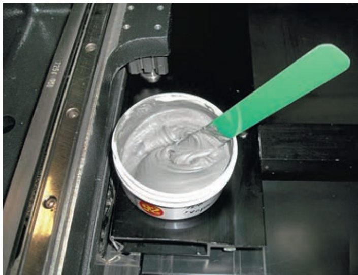
Паяльная паста, подготовленная к работе вручную
