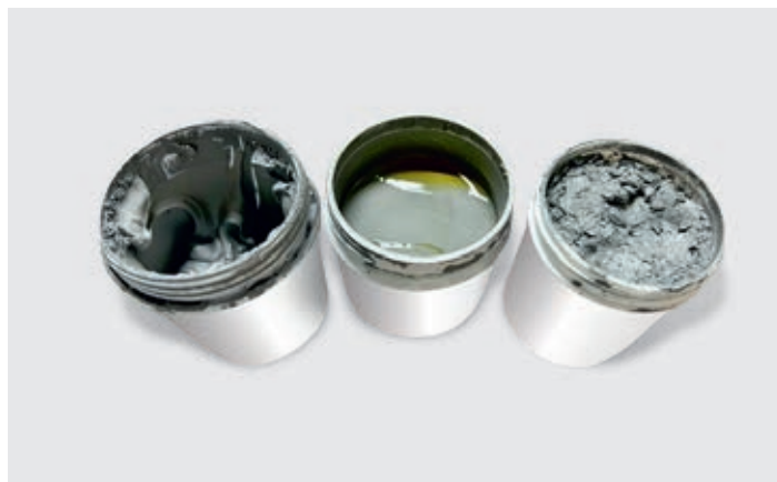
Локальный перегрев паяльной пасты (справа) и исходное состояние после нагрева до комнатной температуры (слева)
